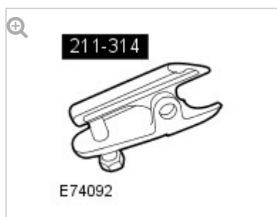
211- 314(LRT-57- 036) Ball joint separator
